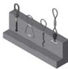
1D hefsysteem met anker met schroefdraad
