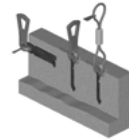
Système de levage par ancrés plates 2D
