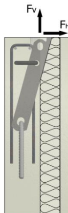
Ancre pour panneau sandwich SA-SP – Capacité de charge, dimensions d'installation
